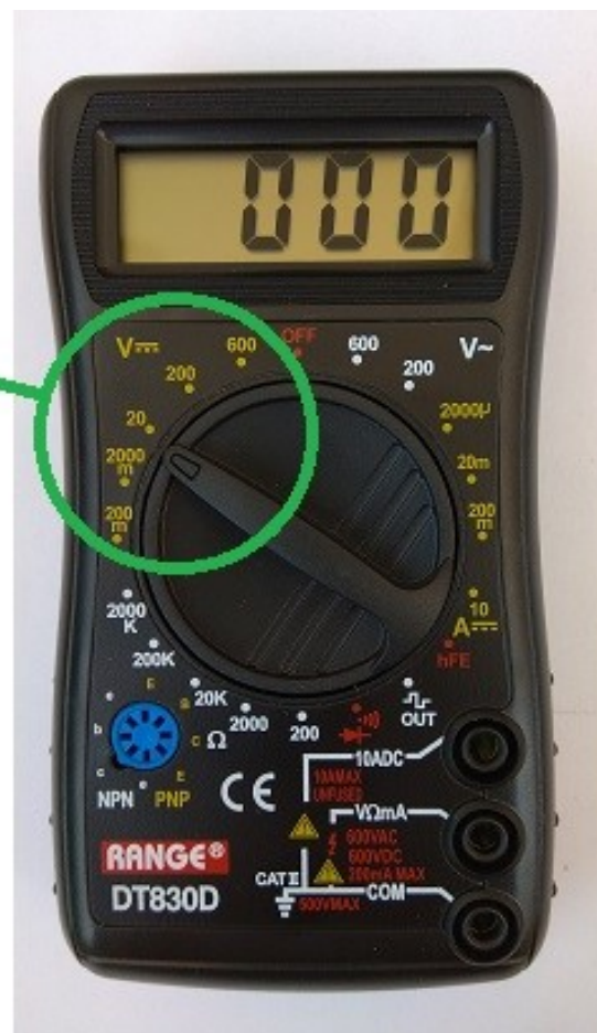
Obrázek 5a.4: Nastavení multimetru pro měření elektrického napětí
