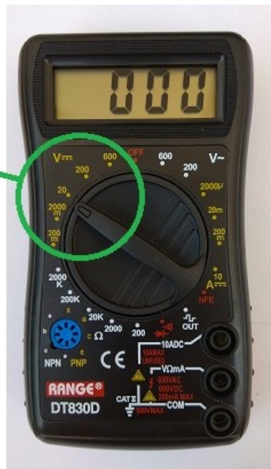
Obrázek 5a.4: Nastavení multimetru pro měření elektrického napětí
