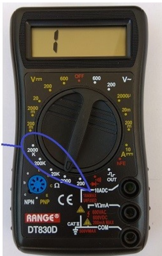
Obrázek 4a.11: Multimetr s vyznačenými rozsahy pro měření elektrického odporu
