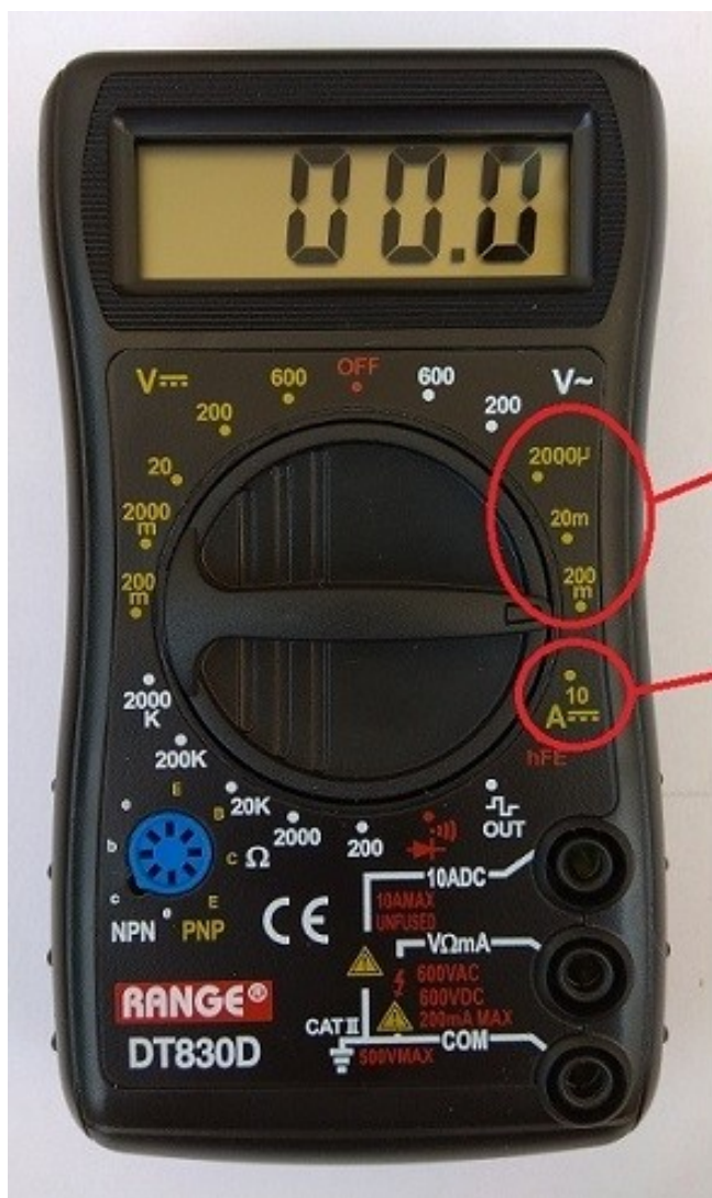
Obrázek 4a.6: Multimetr se zvoleným rozsahem 200mA
