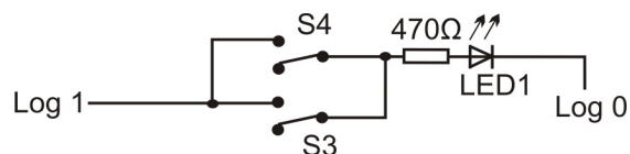
Obrázek 2.5: Funkce OR se spínači
