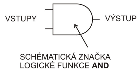
Obrázek 2.2: Tabulka funkce AND a její schematická značka
