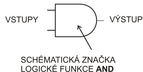
Obrázek 2.2: Tabulka funkce AND a její schematická značka
